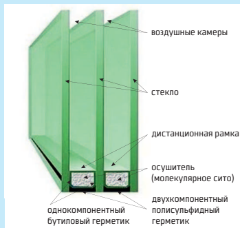
Рисунок №1 (Конструкция двухкамерного стеклопакета)
