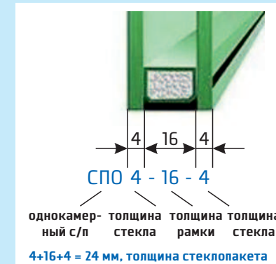
Рисунок №2 (Конструкция однокамерного стеклопакета)
